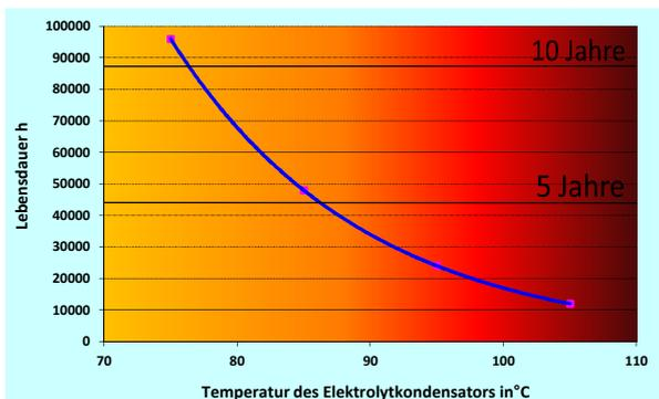
festigkeit. Bei Einhaltung der in den technischen Daten genannten Hinweise bezüglich Einbau und maximaler Gehäusetemperatur ergibt sich für das EVG UVT eine konzipierte Lebensdauer von mindestens 50.000 Stunden. Als Faustregel gilt, dass eine Temperaturänderung von 10K die Lebensdauer des Kondensators verdoppelt bzw. halbiert. Es muss dafür Sorge getragen werden, dass die erlaubte Temperatur am tc-Punkt auch im extremsten Betriebsfall (worst case) nicht überschritten wird.
